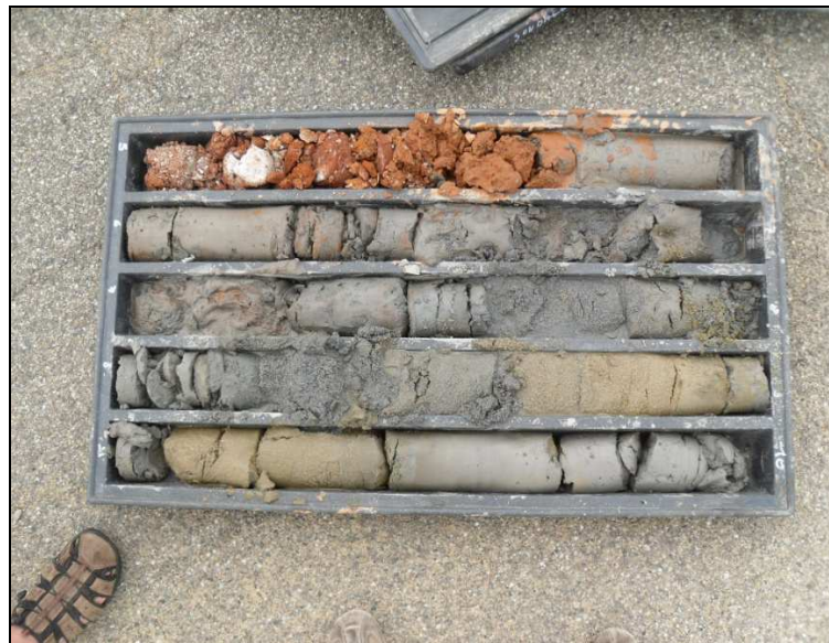
Fig.8: cassetta carotaggio tra -5 m e -10 m
